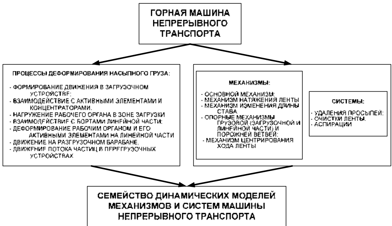
Рис. 1 – Структура формирования динамических моделей механизмов и систем машины непрерывного транспорта на примере ленточного конвейера-питателя
